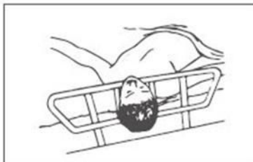
Zone 1 : entre les barreaux de la barrière de lit
